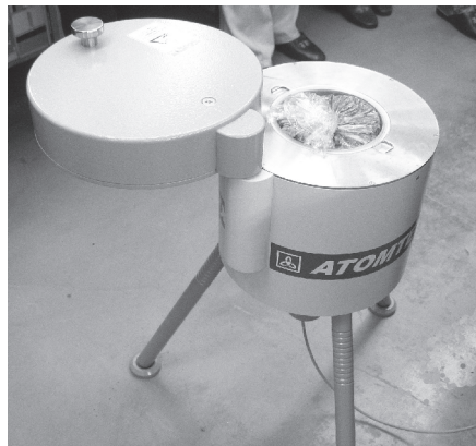
消費者庁より貸与された検査機器 NaI (TI) シンチレーション式簡易ガンマ線スペクトロメータ 測定限界値は 25 ベクレル/kg 検査結果は伊勢原市の HP に掲載。
